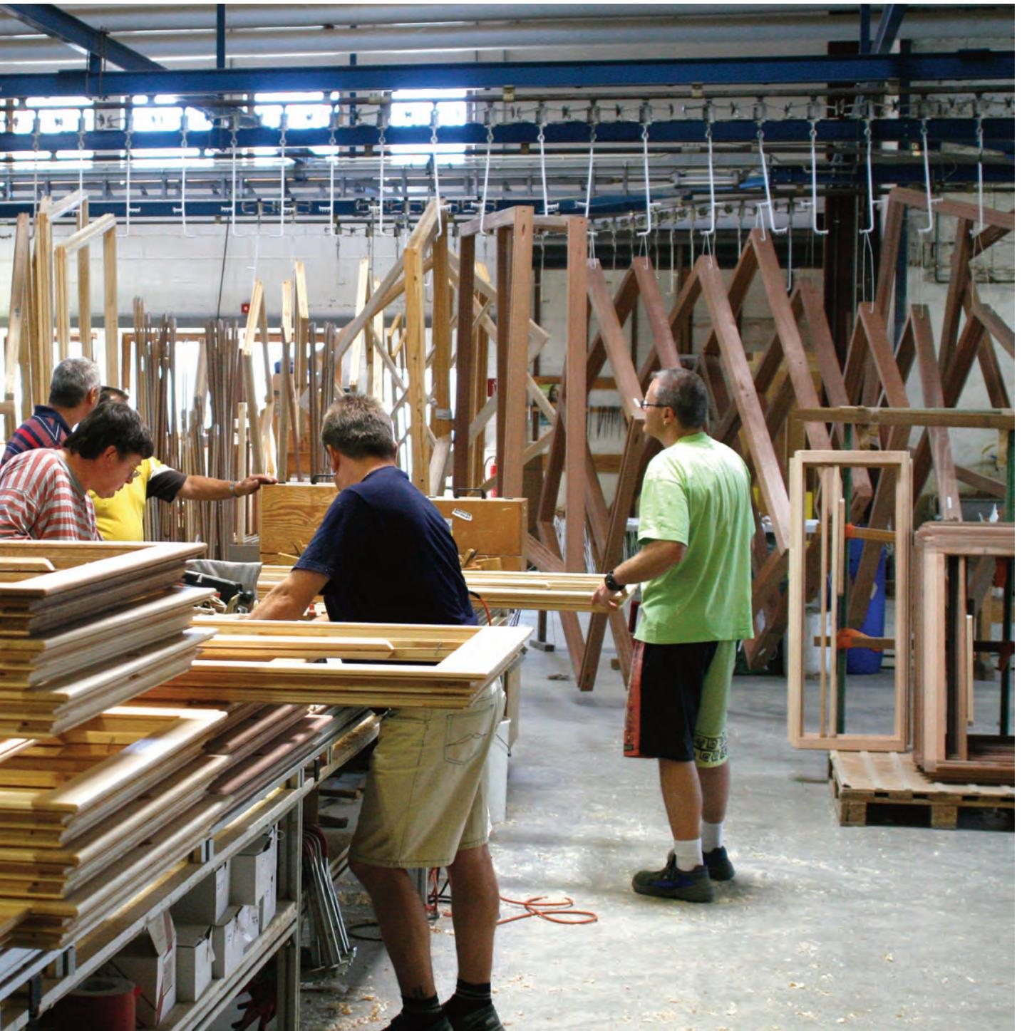
Die Grundlage bildet eine Wässerung mit anschließendem Verschleiff. Der nächste Schritt ist die Grundierung, bevor ein weiterer Zwischenschleiff die idealen Voraussetzungen für die nun folgende Lackierung schafft. Der arbeitsintensive 4-Schicht-Farbaufbau sorgt für eine hervorragende Struktur und erweist sich als ideale Oberflächenveredelung.
